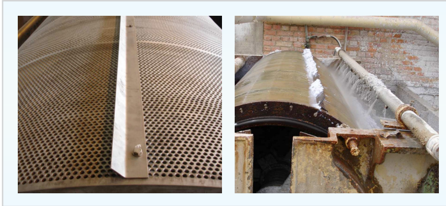
Figura 7: Fijación por regla transversal.
